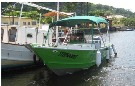
**Figura 0-3 – Voadeira de alumínio de costado alto comumente utilizada na pesca amadora embarcada costeira na APAMLS. Fonte: FF/FUNDEPAG (2015).**
